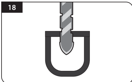
18 Percer un trou de 25mm dans le centre de la Bande de frottement
